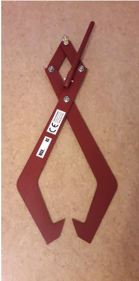
**Eine stabile, aus Stahl gefertigte Holzzange / Verladezange, die zum Schleppen und Verladen von Holz konzipiert ist. Die Zange ist sehr stabil gefertigt und garantiert eine lange Lebensdauer
